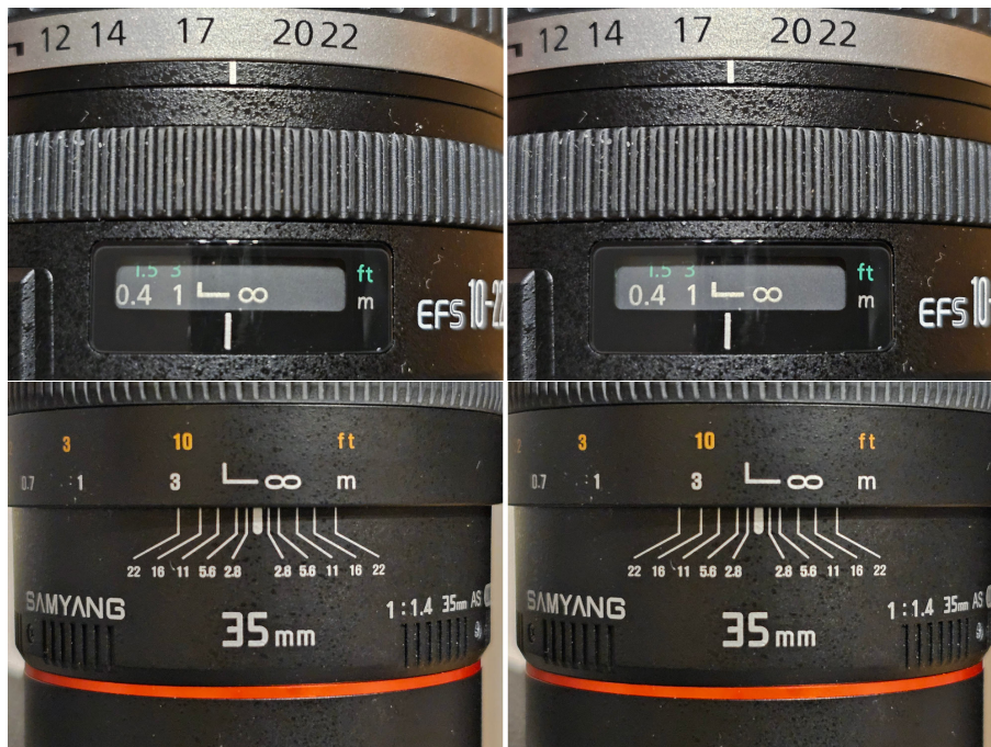
Slika 3.4: Za podešavanje fokusa koristite oznake za udaljenost koje se nalaze na objektivu. Prsten za fokus okrenite na beskonačno (slike lijevo), a zatim ga za vrlo sitan pomak okrenite u suprotnom smjeru (slike desno). Kod jeftinih objektivu postoji mogućnost da nisu upisane oznake za udaljenost. U tom slučaju kako bi prsten za fokus postavili na beskonačno, okrenite ga skroz ulijevo.
