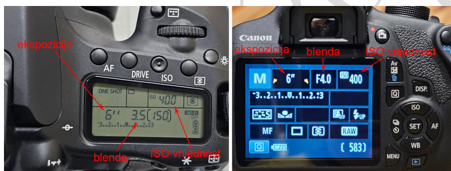
Slika 3.2: Izbornik fotoaparata, gdje se mogu pratiti vrijednosti ekspozicije, blende i ISO vrijednosti.
