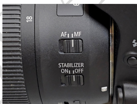
Slika 3.3: Isključivanje automatskog fokusa i stabilizacije slike ovisi o vrsti objektivu kojeg koristite. Za isključiti automatsko fokusiranje objektivu, prekidač s AF (auto fokus) prebacite na MF (manual fokus). Kod nekih objektivu oznake mogu biti samo A i M, a M opet znači "manual fokus". Stabilizaciju nemaju svi objektivu. Ako vaš objektiv ima stabilizaciju, prekidač stavite na OFF.
