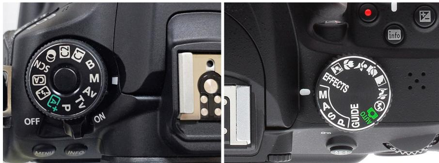
Slika 3.1: Aktiviranje ručnog načina rada, prebacivanjem prekidača na oznaku "M".
