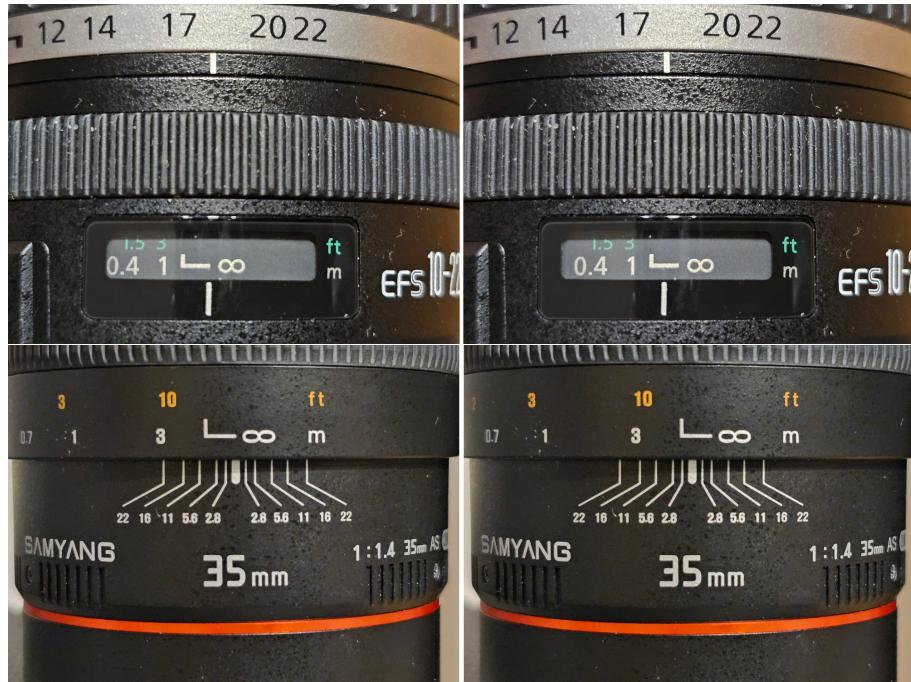
**Slika 3.4:** Za podešavanje fokusa koristite oznake za udaljenost koje se nalaze na objektivu. Prsten za fokus okrenite na beskonačno (slike lijevo), a zatim ga za vrlo sitan pomak okrenite u suprotnom smjeru (slike desno). Kod jeftinih objektiva postoji mogućnost da nisu upisane oznake za udaljenost. U tom slučaju kako bi prsten za fokus postavili na beskonačno, okrenite ga skroz ulijevo.
