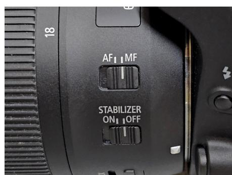
Slika 3.3: Isključivanje automatskog fokusa i stabilizacije slike ovisi o vrsti objektiva kojeg koristite. Za isključili automatsko fokusiranje objektiva, prekidač s AF (auto fokus) prebacite na MF (manual fokus). Kod nekih objektiva oznaće mogu biti samo A i M, a M opet znači "manual fokus". Stabilizaciju nemaju svi objektivi. Ako vaš objektiv ima stabilizaciju, prekidač stavite na OFF.
